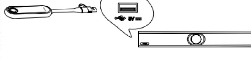
1. Verbinden Sie den WPP30 mit dem USB-A-Anschluss des Endpunkts.
