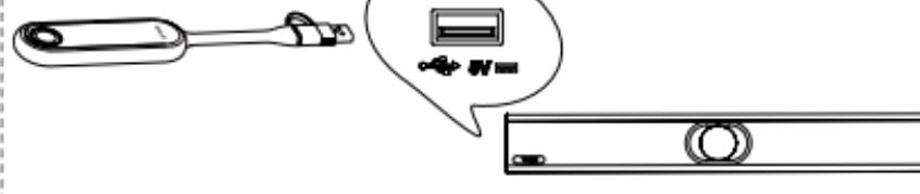
1. 将无线投屏器插到会议主机的 USB-A 口上。
